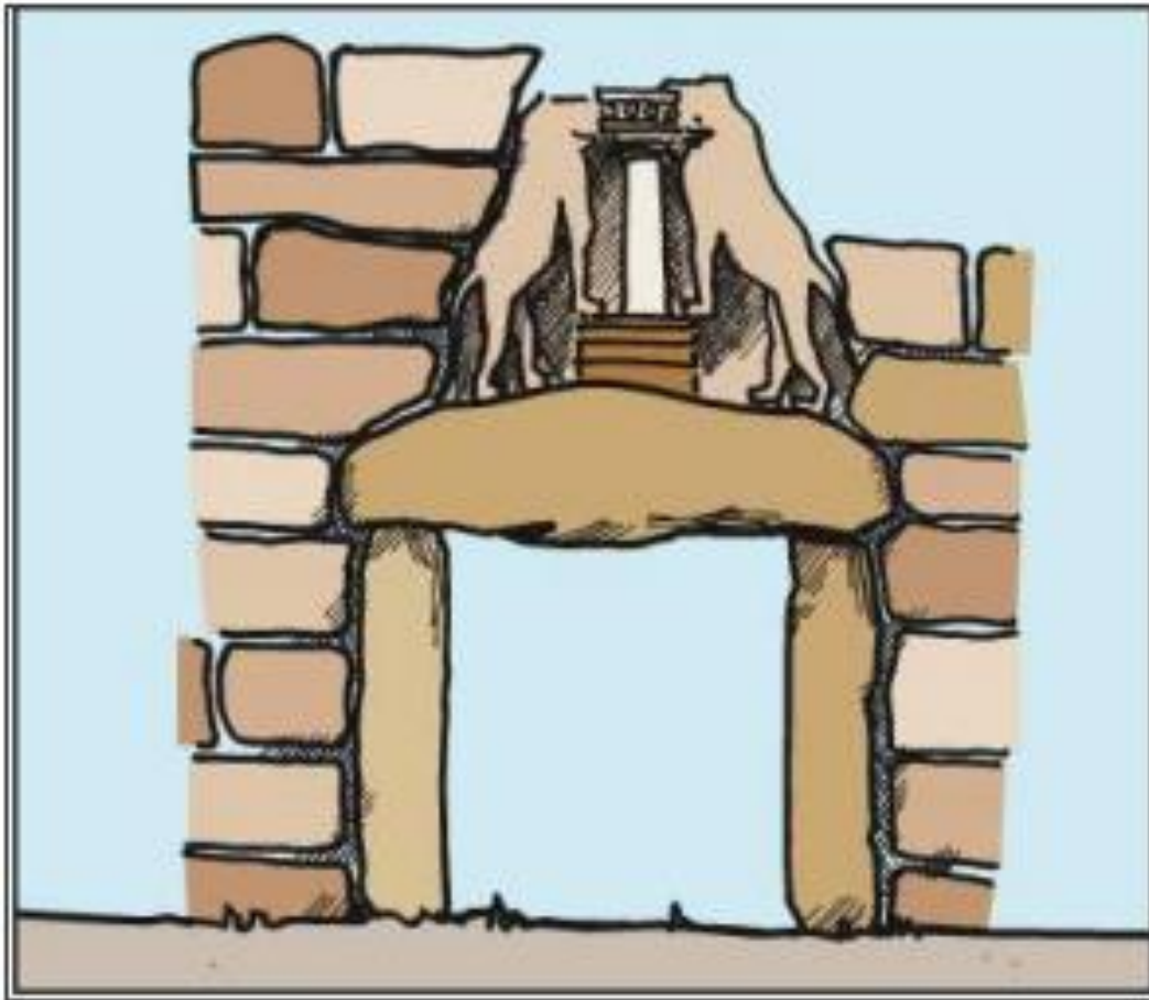
Gambar 1.1 Struktur post and lintel Bangunan Batu di Mesir
